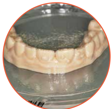
Tiefziehen der Aligner-Schienen
